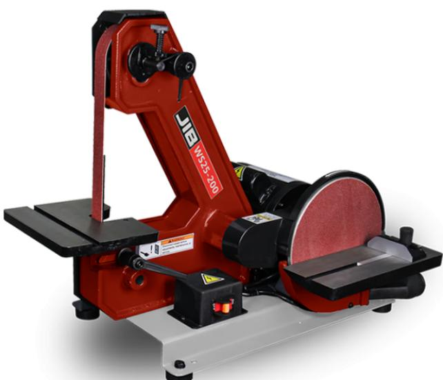
Закрытый асинхронный двигатель мощностью 250Вт обеспечивает точную, бесшумную и надежную работу станка.
