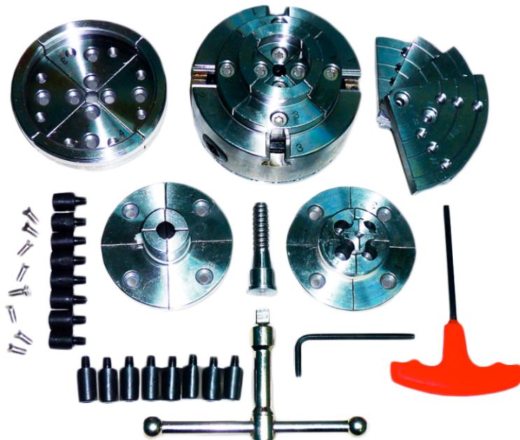
Набор патронов для токарного станка станка 95 мм
