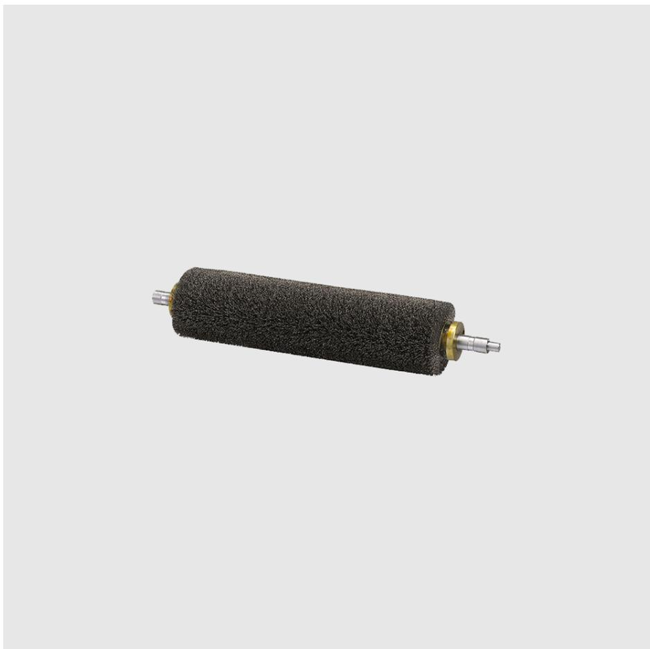
Металлическая брашировальная щетка для Laguna 19-38 Combo Применяется для браширования с эффектом старения. Выбирает мягкие волокна из древесины. Идеально подходит для мягкой и среднетвердой древесины. Диаметр проволоки 0,4 мм Материал проволоки - нержавеющая сталь В комплекте подшипники и муфта
